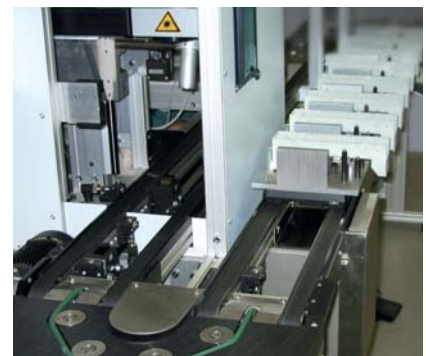
Prozessintegration. Die schnelle Beschriftbarkeit ermöglicht die Integration in eine automatisierte In-Line Fertigung.
